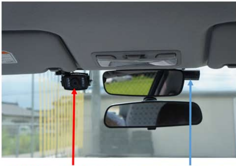
車内撮影用ハイビジョンカメラ(IR内蔵) 前方撮影用ハイビジョンカメラ
